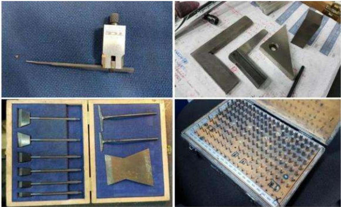
Рисунок 2 – Типичные инструменты для измерения матриц [1]
